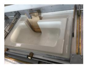
Il nostro parco macchine si compone di presse per la termoformatura sottovuoto con un range di applicazione da una dimensione minima di mm 400×400 h 600 a una massima di mm 2500×1500 h 1300. Le materie plastiche oggetto delle nostre lavorazioni sono: ABS, ABS + PMMA, ABS AUTOESTINGUENTE, PS/PST, PMMA, POLICARBONATO, PVC, HDPE, PET.
